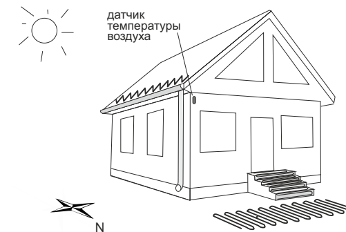
Рисунок 1. Монтаж датчика температуры воздуха
