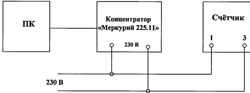
**Рисунок А.1 - Схема для проверки функционирования PLC-модема**
